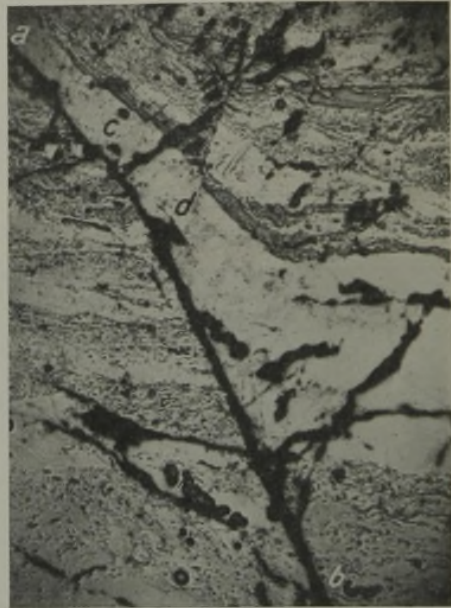
Abb. 10. Sprünge in der Kohle. 7,5 \times , trocken.
