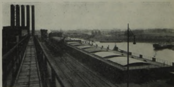
Abb. 13. Kastenreiniger für 1200000 m 3 /Tag auf der Zentralkokerei Nordstern der Gelsenkirchener Bergwerks-AG., Gruppe Gelsenkirchen.
