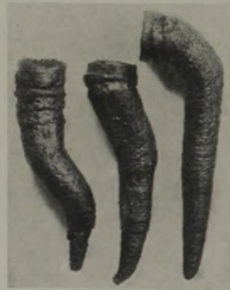
Abb. 18. Tiegelkokse von Reinkohlenfraktionen aus den Waschbergen und der gewaschenen Feinkohle (Bergeaustrag 4, Überläufe I und II). Etwa \frac{3}{5} nat. Größe.
