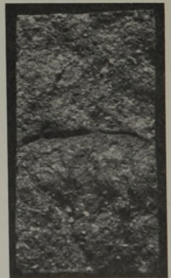
Abb. 5. Bruch durch einen Normalstein mit kennzeichnendem, durch die Schneckenwelle der Batzenpresse hervorgerufenem Lunker.
