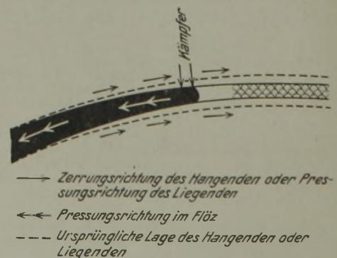
Abb. 2. Überzugswirkungen und Lage des Kämpfers bei Vermeidung von Druckgewölben.
