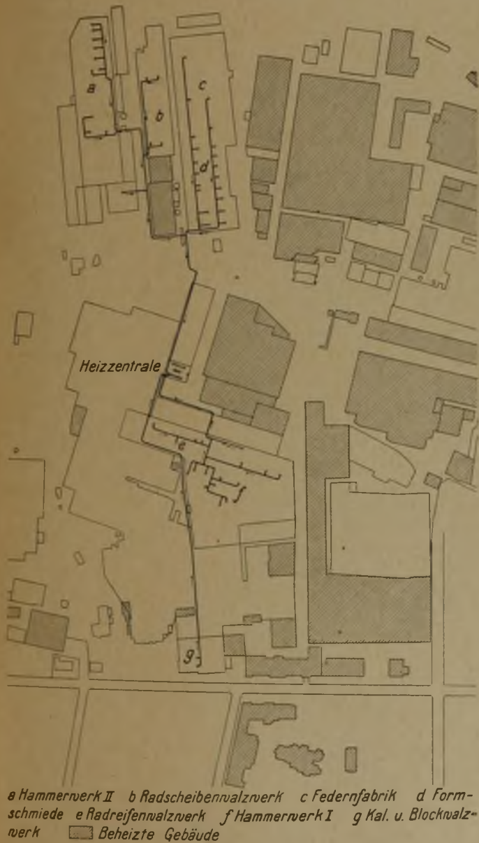
Abb. 4. Lageplan der Abwärmequellen, Heizzentrale und beheizten Gebäude.
