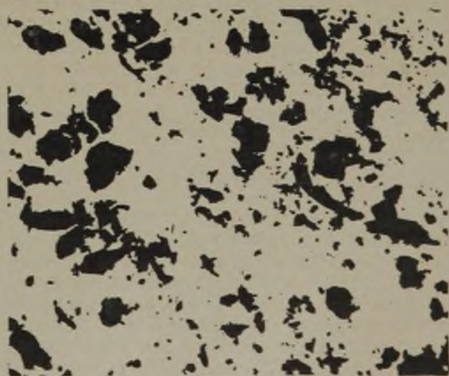
Abb. 1. Durch ein 5000-Maschen-Sieb gegangener Magerkohlenstaub in hundertfacher Vergrößerung.
