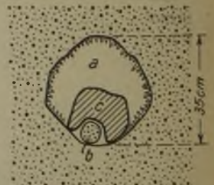
Abb. 13. Hohlraum (a) mit verkieselten Stammresten (b und c) im Sandstein über Flöz Plaßhofsbank auf der Zeche Constantin 7/8
