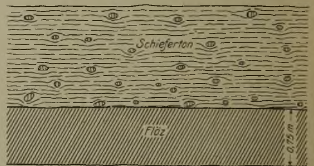
Abb. 19. Hangender Schieferton mit Sphärosideritkondensationen (Nüssen).
