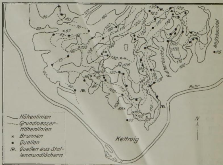
Abb. 3. Grundwasser-Höhenlinien nördlich von Kettwig.
