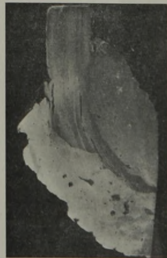
Abb. 5. Längsschnitt durch die Schweißstelle in Abb. 4.
