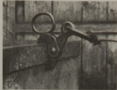
Abb. 6. Sicherheitshaken für Streckenhaspel.
