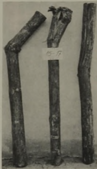
Abb. 2. Stempel 15–17 vor dem Brandversuch.
