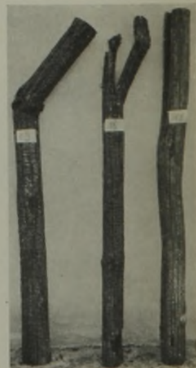
Abb. 9. Stempel 15–17 nach dem Brandversuch.
