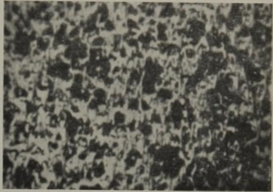
Abb. 2. Schliffbild des Hochtemperaturkokes aus Kohle I.  $v = 150$ .
