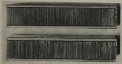
Abb. 7. Plattenpakete, oben ordnungsmäßig, unten unbrauchbar wegen einzelner unzulässig weiter Spalte.
