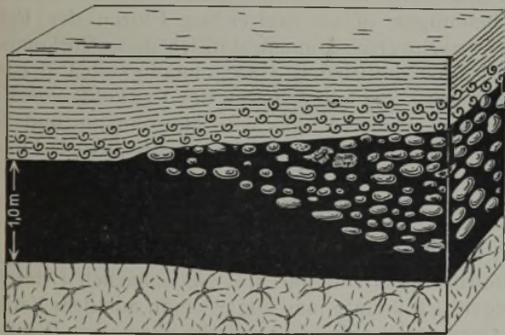
Abb. 4. Einlagerung von Torfdolomiten im Flöz Katharina unter Zunahme der Flözmächtigkeit.
