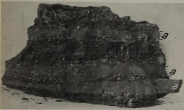
Abb. 6. Quarzstreifen (a) in Glanzkohle des Flözes 8 der Zeche Sachsen. \frac{1}{2} nat. Gr.
