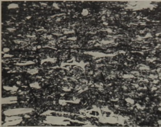
Abb. 12. Brandschiefer aus der Bank 8 des Flözes Robert der Zeche de Wendel. v = 250 .
