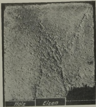
Abb. 13. Bildung eines Druckkeiles über der starren Platte und eines Gewölbes über der Hohlform.
