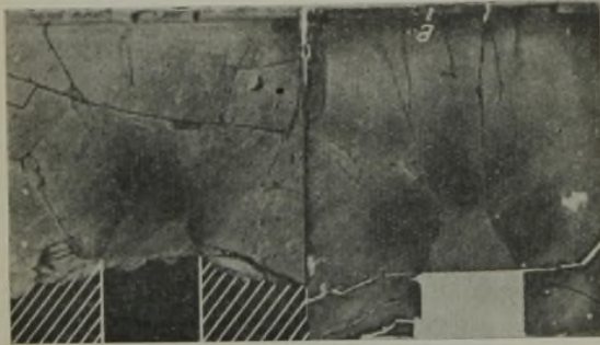
Abb. 7. Bildung eines festen Kernes über der Druckplatte. Der Versuch rechts mit der weichen Zwischenschicht a zeigt trotz geringerer Einpressung eine tiefergehende Zerstörungszone (dunkle Schatten) als der Versuch links.
