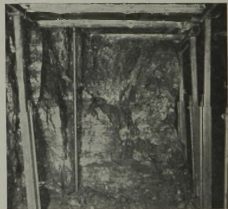
Abb. 3 1 . Aufspaltung am Kohlenstoß und Drucklagen 2 im Flöz Wilhelm der Zeche Hansa.
