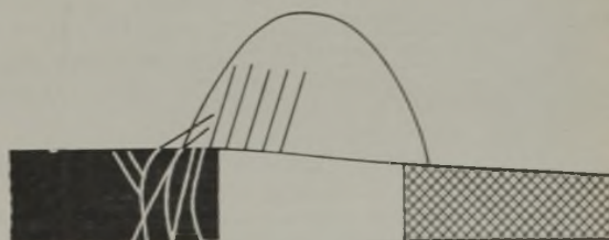
Abb. 2. Rißbildung am Abbaustoß (sekundär).
