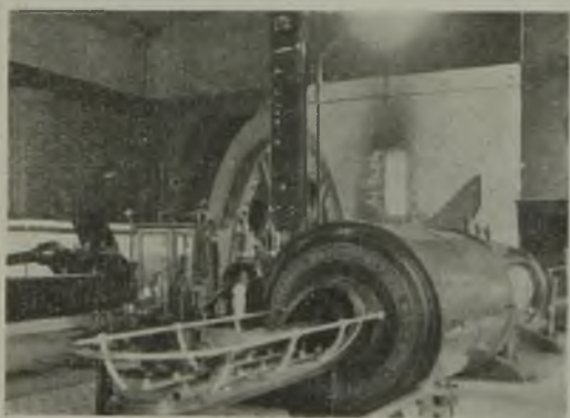
Abb. 8. Ansicht der umgebauten Fördermaschine.
