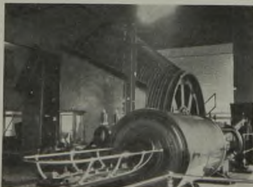
Abb. 3. Ansicht der Fördermaschine.
