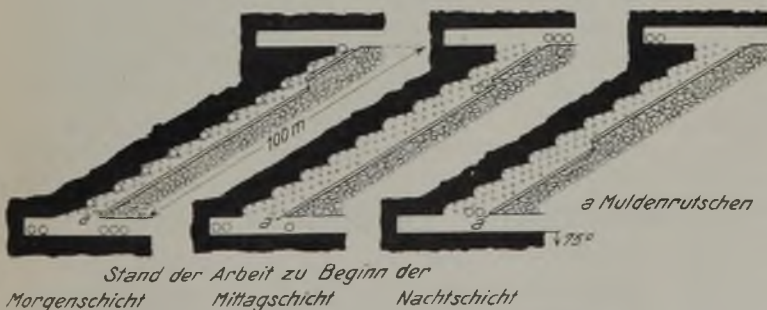
Abb. 17. Schrägstoß mit sägeblattartigem Verhieb.
