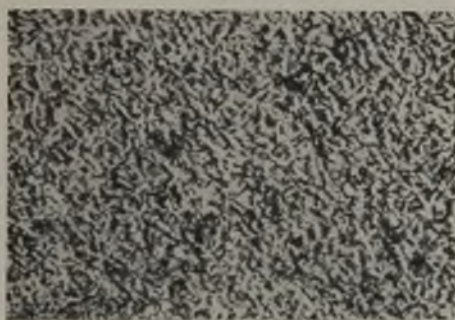
Abb. 22. Feingefüge im hartvergüteten Zustand.
