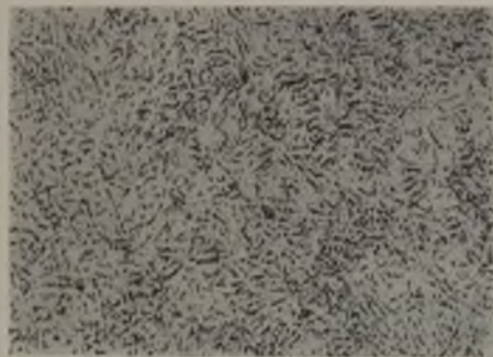
Abb. 21. Gefüge eines sachgemäß gehärteten Bohrers.
