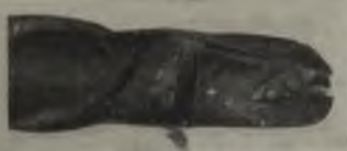
Abb. 12. Schneide, infolge Einschmiedens der Schlange beim Bohren ausgebrochen.
