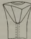
Abb. 15. Vom Spülloch herrührende unganze Stellen in einer Hohlbohrerschneide.
