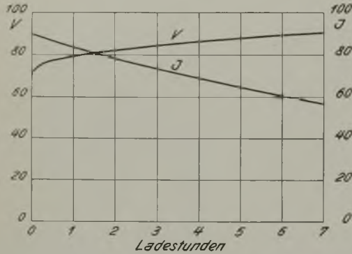
Abb. 1. Ladekennlinien einer Eisen-Kadmium-Batterie von 50 Zellen, 90 A.
