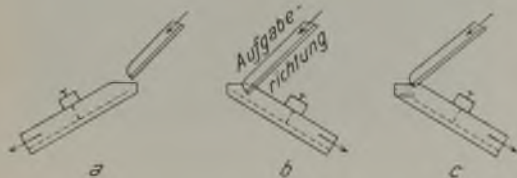
Abb. 10. Verschiedenartige Aufgabemöglichkeiten für ein Sieb.
