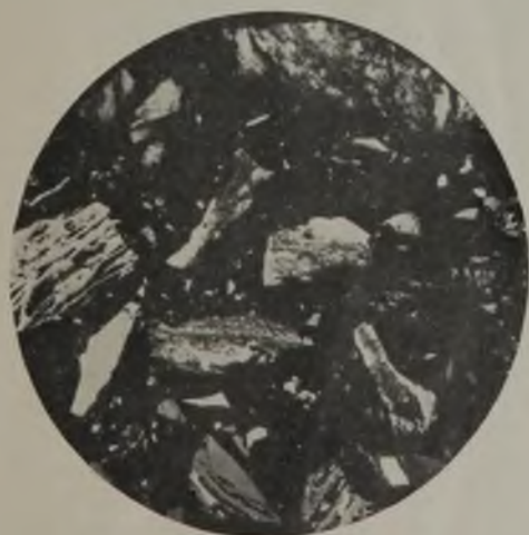
Abb. 12. Duritanreicherung, Grube 8. v = 80, Öl.
