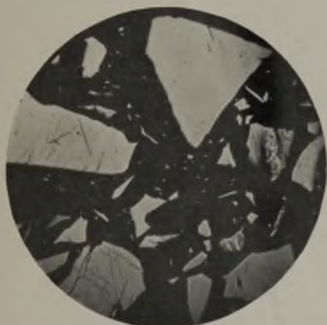
Abb. 11. Vitritanreicherung, Grube 8. v = 80, Öl.
