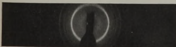
Abb. 7. Tief-Cristobalit aus Quarzglas, durch Entglasen bei 1450° C hergestellt.
