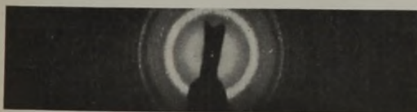
Abb. 6. Ohne Zusätze hergestellter Silikakoksofenstein. d = 2,34; fast nur Tridymit.
