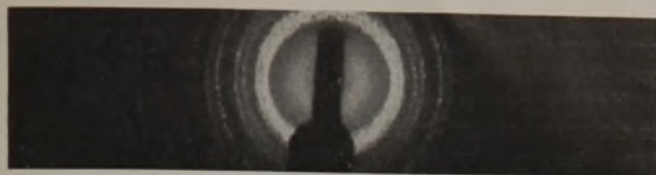
Abb. 2. Tridymit, synthetisch von Dr. A. Zwetsch. (0,1–0,2 mm Dmr.)
