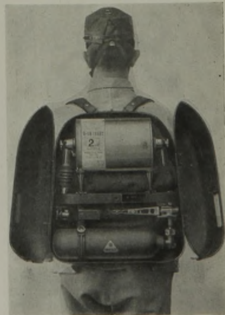
Abb. 2. Ansicht des Dräger-Gasschutzgerätes Mod. 160.
