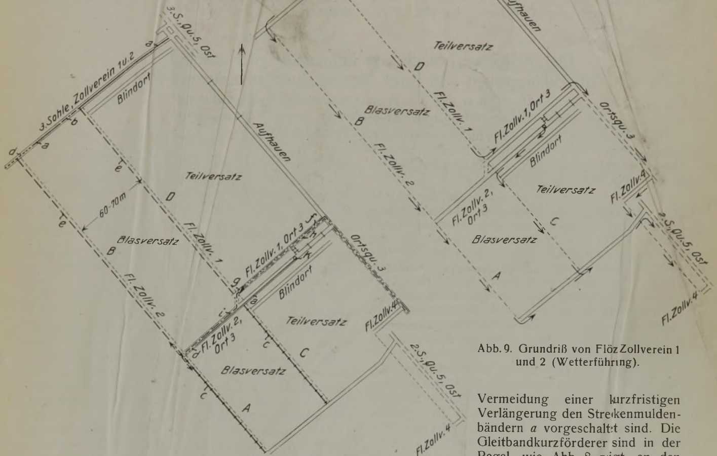
Abb. 7. Grundriß von Flöz Zollverein 1 und 2 (Förderbetrieb).
