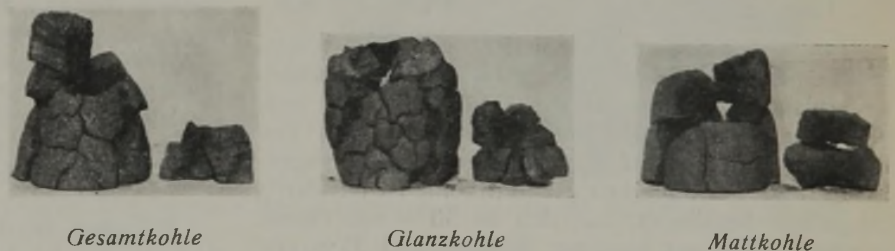
Abb. 2. Retortenkoks, bei 950° aus Kohle des Flözes Bismarck und ihren geklaubten Gefügebestandteilen hergestellt.
