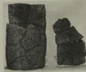
Abb. 10. Retorten-Schwelkoks aus oberschlesischer Backkohle.
