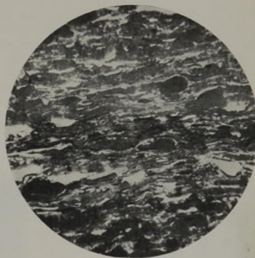
Abb. 3. Feingefüge des Durits der Grube 13. v = 225, Öl.
