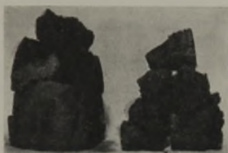
Abb. 12. Retorten-Schwelkoks aus einer Mischung von 70 % Ruhrgaskohle und 30 % Boghead-Kannelkohle.
