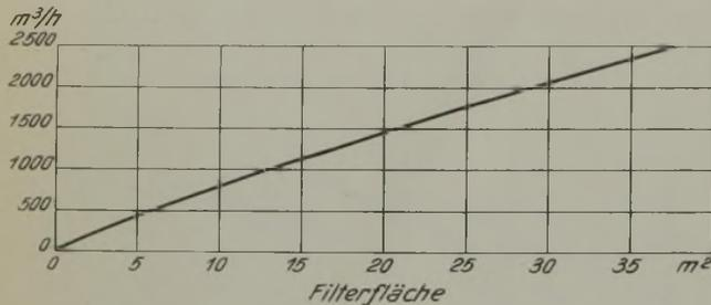
Abb. 9. Luftverbrauch in Abhängigkeit von der Größe der Filterfläche.
