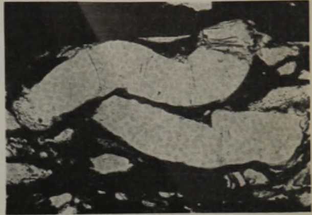
Abb. 6. Dünnschliff durch die Aschenlage im Neuflöz 3 der Gewerkschaft Gottes Segen in Ölsnitz (Kaolinwürmer) v = 233.
