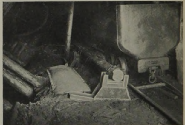
Abb. 6. Bergekippe mit Kippschiene und Kippbock.
