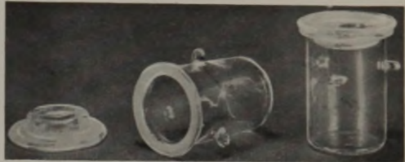
Abb. 1. Quarztiegel für die Bestimmung im elektrisch geheizten Muffelofen.
