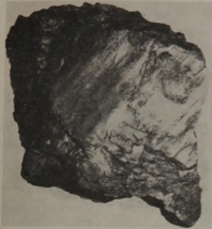
Abb. 8. Brandschiefer mit Rutschflächen aus dem Rothell-Querschlag, 5. Tiefbausohle.
