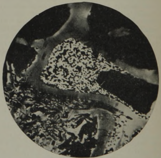
Abb. 20. Natürlicher Koks des Flöz 7 Süd (Grube Heinitz). Fusitischer Rest im Koks. Holzzelle, in der sich Graphitkristalle (hell) ausgeschieden haben. Schwarz: Poren. Anschliff unter Öl, 500 × (Stach).
