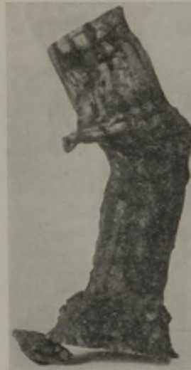
Abb. 6. Flachgedrückter und plastisch gewordener Holzstempel aus dem Bergeversatz von Flöz Mathilde. Spezifisches Gewicht = 1,25.
