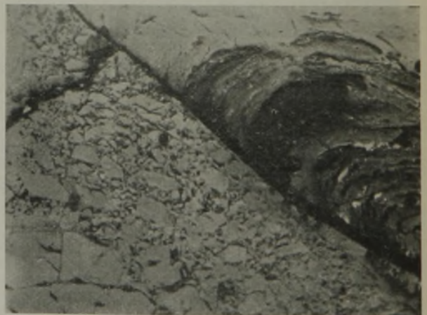
Abb. 12. Zertrümmerter Vitrit an einer Überschiebung aus Flöz Wolwerth (Petite Rosselle, Frankreich). v = 200 \times .
