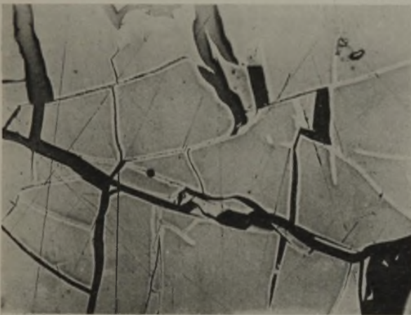
Abb. 2. Beginnende Oxydation an den Rissen im Vitrit von Flöz Albert. v = 180 \times .
