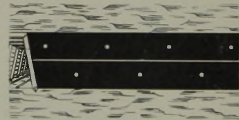
Abb. 15. Auflockerungsschüsse in Ober- und Unterbank eines Flözes.
