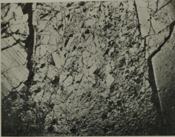
Abb. 9. Beginnende Zerstörung des Gefüges (Druckkeil). 8 \times , Milar, natürlicher Verband im Stückschliff.
