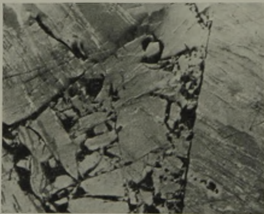
Abb. 10. Bruchformen der Gefügebestandteile. 690 \times , Ölimmersion, natürlicher Verband im Stückschliff.
