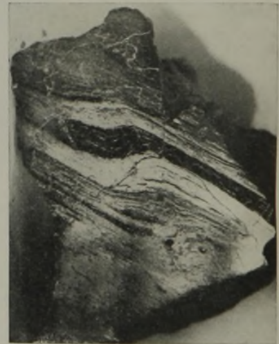
Abb. 20. Hakensschlag in der Kohle im Zusammenhang mit der Bildung von Silberstreifen. \frac{3}{4} nat. Gr. (Anschliff im Schräglicht).
