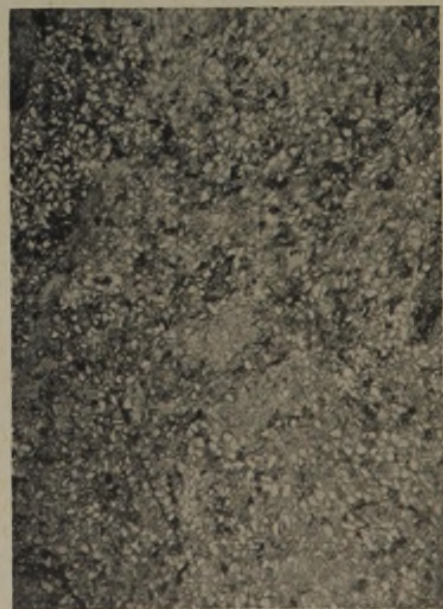
Abb. 7. Dünnschliffbild des Kalksandsteins der Zeche Oespel, 22,5 \times . Aufnahme Leitz.
