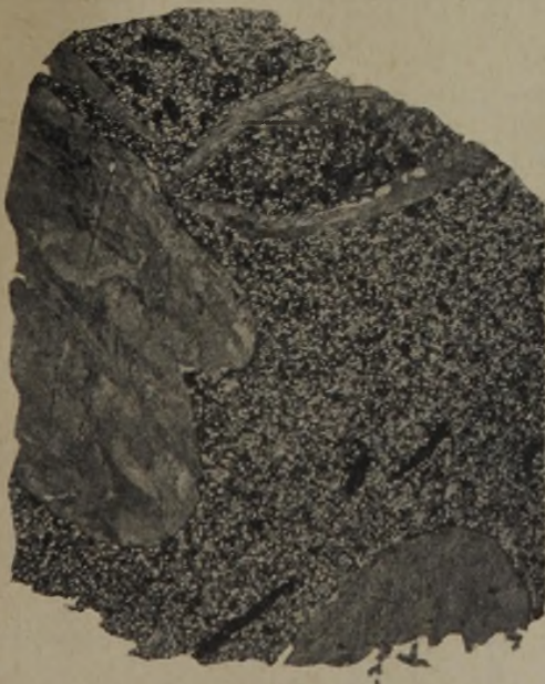
Abb. 5. Dünnschliffbild des Kalksandsteins der Zeche Fröhliche Morgensonne, 3 \times . Aufnahme Leitz.
