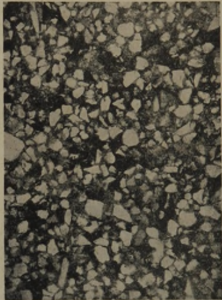
Abb. 6. Dünnschliffbild des Kalksandsteins der Zeche Fröhliche Morgensonne, 22,5 \times . Aufnahme Leitz.
