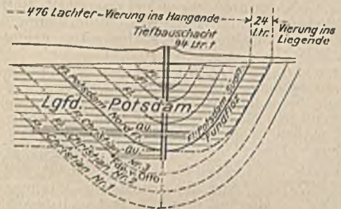
Abb. 9. Streckung des Längenfeldes Potsdam mit geodätischer Vierung.
