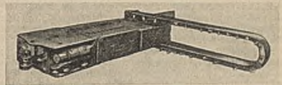
Abb. 13. Schrämmaschine mit ringförmigem Ausleger.
