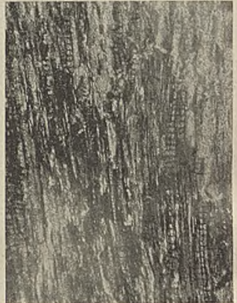
Abb. 8. Längsschliff (tangential) des Holzes von Zeche Sachsen mit den Querschnitten der Markstrahlen. Vergr. rd. 24 : 1.
