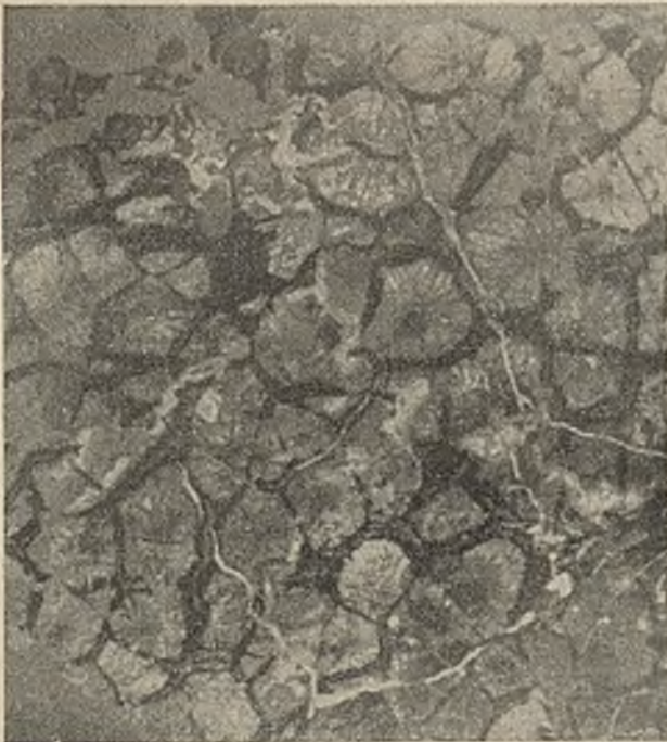
Abb. 1. Dünnschliff durch ein dolomitisches Sphärolith-Holz aus Flöz 22 (= Flöz Blücher der Einheitsbezeichnung) der Fettkohle in der Zeche Hibernia. Vergr. 2,7 : 1.
