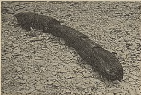
Abb. 3. Dolomitisierter Baumstamm, gefunden beim Abteufen des Schachtes 3 der Zeche Sachsen in 860 m Teufe, Länge des Stammes rd. 2,80 m.
