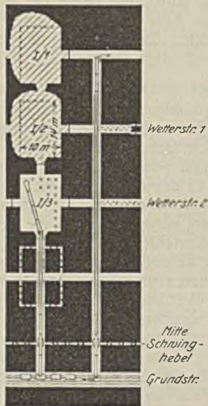
Abb. 7. Kammerbruchbau mit maschinenmäßiger Förderung.
