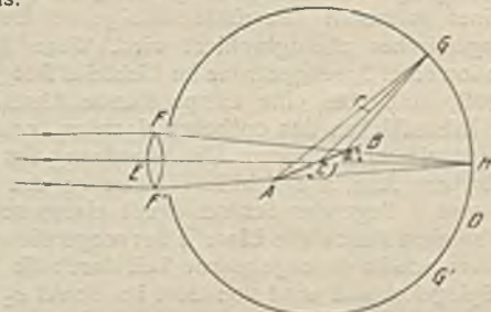
Abb. 3. Grundgedanke des Lichtbildgeräts mit umlaufendem Spiegel.
