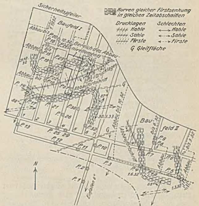
Abb. 9. Rißauszug vom Flöz X Ostfeld mit Lotpunkten, Schlechten und Drucklagen. M. 1: 4000.
