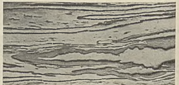
Abb. 4. Sporenclarit und Kutikulenclarit. v=95 , trocken.
