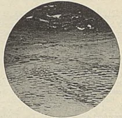
Abb. 3. Vitrit mit Zellgefüge. v=67 , Ölimmersion.
