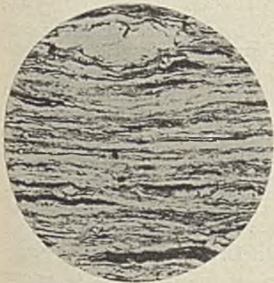
Abb. 7. Links: Brandschiefer mit viel Asche und wenig Pyrit. v=132 , Ölimmersion. Rechts: Brandschiefer mit wenig Asche und viel Pyrit. v=82 , Ölimmersion.
