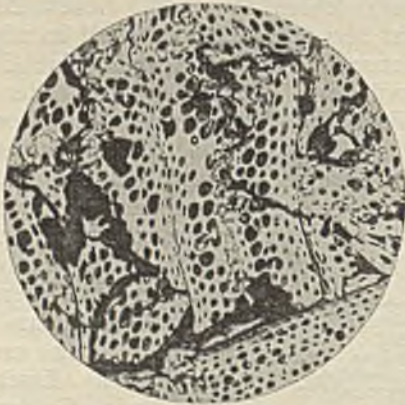
Abb. 2. Fusit mit guter Holzstruktur. v=82 , trocken.
