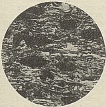
Abb. 6. Bogheadkennelkohle mit deutlich erkennbaren Algenresten. v=274 , Ölimmersion.
