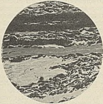
Abb. 5. Durit mit Makro- und Mikrosporen und überwiegender Opaksubstanz. v=132 , Ölimmersion.
