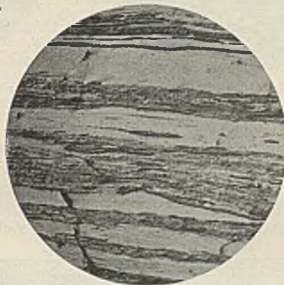
Abb. 9. Typische Streifenkohle, in Vitritlagen Zellgefüge zu erkennen. v=7 , Milar.
