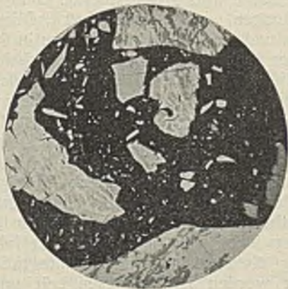
Abb. 27. Körnerschliff einer mittlern Fettkohle mit weniger gut erhaltenen Pflanzenresten. v = 132 , Ölimmersion.
