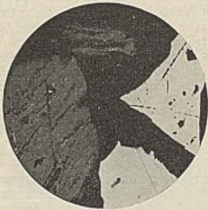
Abb. 30. Körnerschliff mit Anthrazit, unterer Fettkohle und Gasflammkohle. v = 132 , Öl-immersion.
