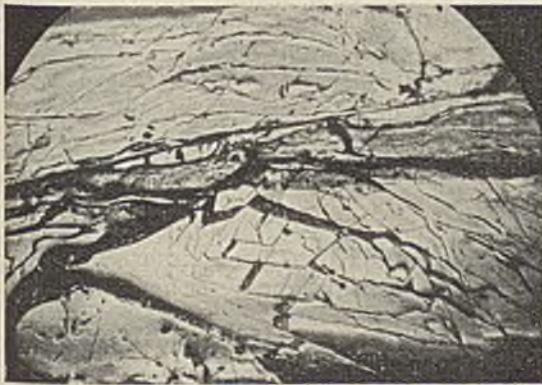
Abb. 10. Gefügezerstörungen durch Zusammenschub (unten zerbrechende Glanzkohle). v = 120.
