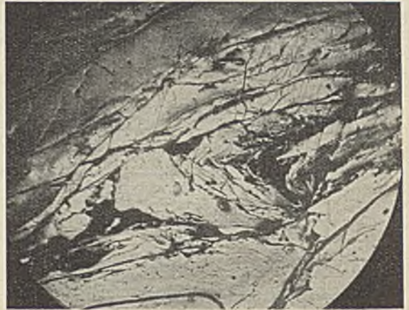
Abb. 7. Stark zerklüftete und verworfene Glanzkohle und Mattkohle. v = 120 .
