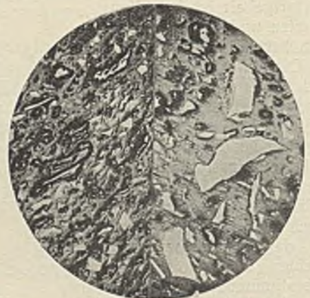
Abb. 5. Ergebnis der Flotation des Sichterstaubes einer Ruhrfettkohle durch Zugabe wasserlöslicher Oxydationsmittel.
