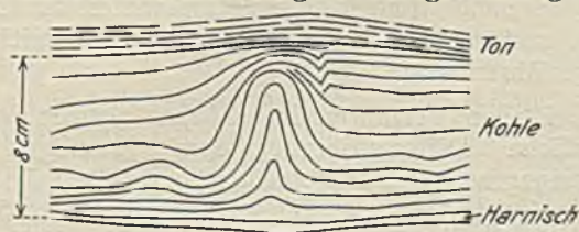
Abb. 2. Durch seitlichen Druck zusammengeschobene Kohle aus dem Antonflöz.
