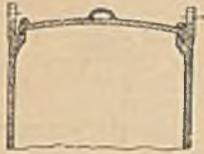
Durchtritt der Luft von außen nach innen bei der Abkühlung der Kasten aber verhindert. Behufs Vermeidung einer Oxydation des Metalls bestreut man die Rinne mit Kohlenpulver, oder setzt über den Deckel noch einen zweiten Deckel.
