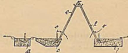
rolle liegt, in das Zinnbad *i*. Um eine Oxydation des heißen Drahtes innerhalb des Kanals *e* zu verhindern, wird in denselben ein trocknes indifferentes Gas eingeführt, während die Außenseite des Kanals *e* durch Berieseln mit Wasser, welches bei *o* gesammelt und abgeführt wird, gekühlt wird.
