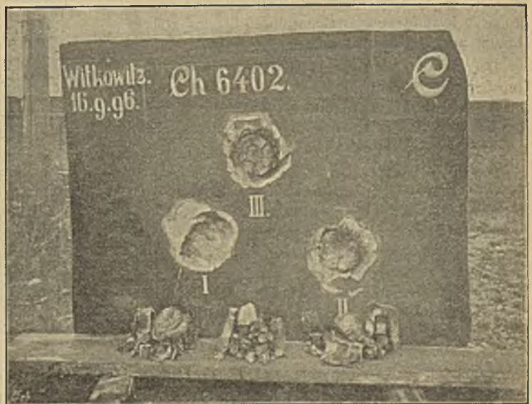
Abbild. I Vorderseite der Platte Ch 6402 nach dem Beschufe.
